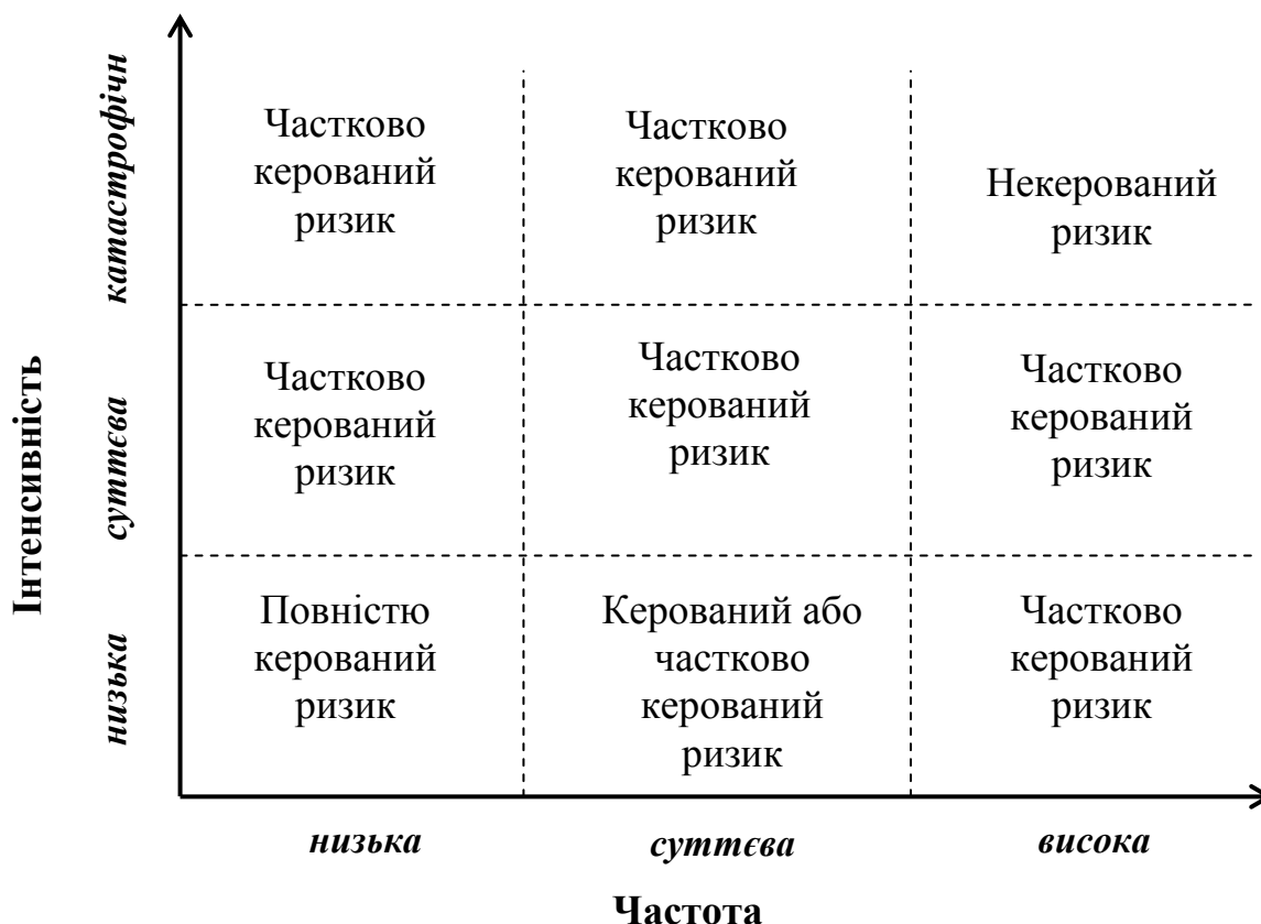
Рис. 1. Оцінка ризиків з позиції інтенсивності та частоти настання несприятливих подій і наслідків їх взаємного накладання [Авторське узагальнення].
