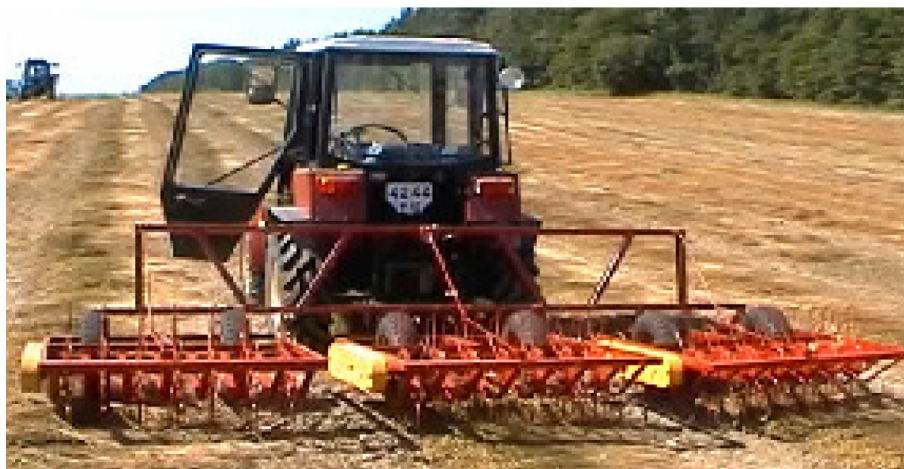
Рисунок 1. – Ворошилка лент льна ВЛК-3М в агрегате с трактором «Беларус 82» при выполнении технологического процесса
