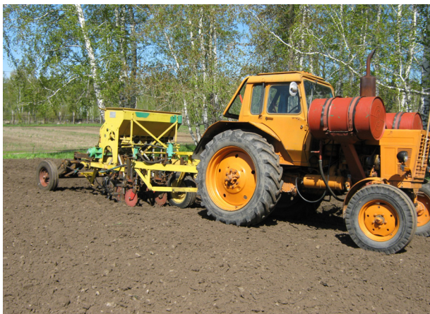
Рисунок 2. – Общий вид экспериментального образца технического средства для внесения в почву жидких форм бактериальных препаратов одновременно с посевом
