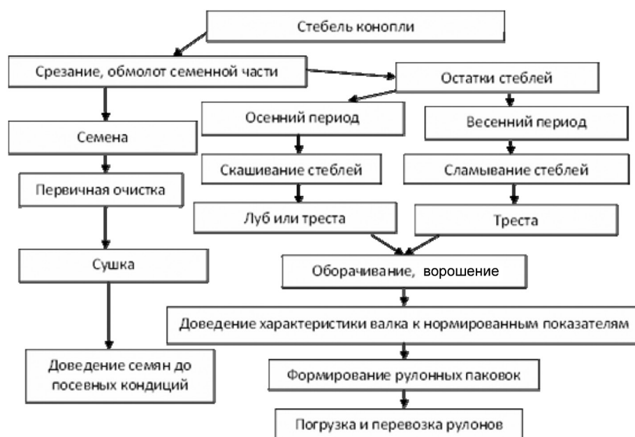
Рисунок 1. – Технология уборки промышленной конопли с использованием с.-х. машин общего назначения
