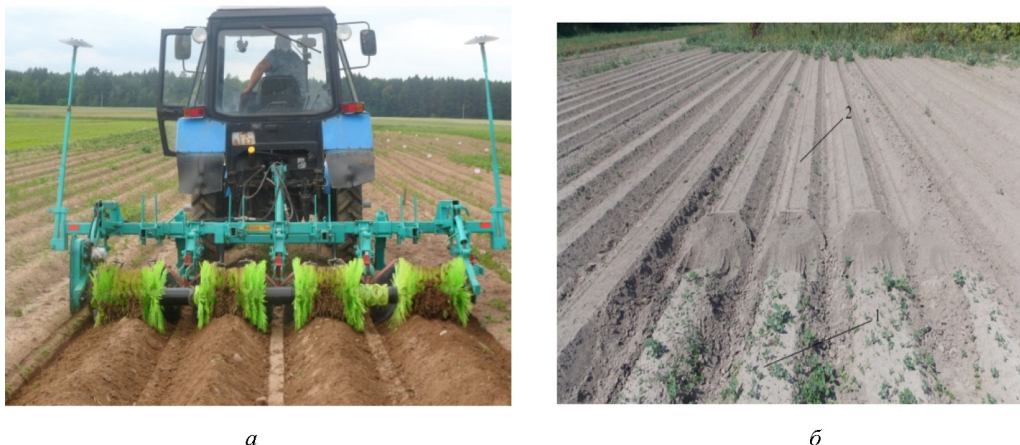
а) вид сзади щеточного барабана для обработки гребней; б) 1 – гребни до обработки; 2 – после обработки Рисунок 2. – Культиватор со щеточным барабаном для обработки гребней картофеля и моркови и общий вид гребней до и после прохождения культиватора со щеточными барабанами
