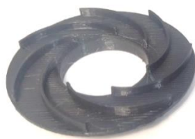
Рисунок 3 – Моделі робочих коліс, надрукованих на 3D-принтері
