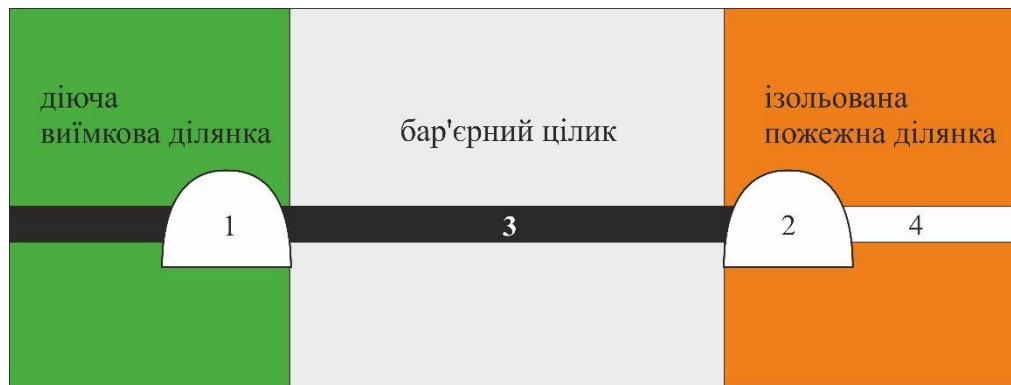
Рисунок 1. Схема розташування гірничих виробок: 1 – діюча виробка; 2 – виробка ізолюваної ділянки; 3 – вугільний пласт; 4 – вироблений простір.
