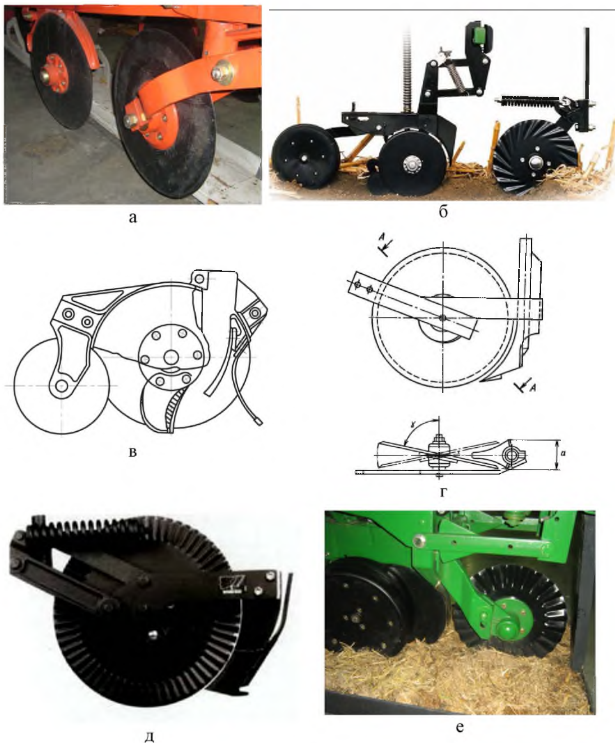
Рис. 1.8 Сошники з додатковим диском для попередньої підготовки борозни:
