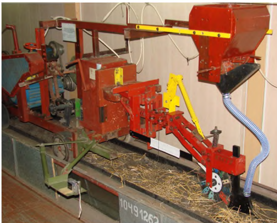
Рис. 3.12 Візок з електромеханічним приводом для дослідження посівних і ґрунтообробних робочих органів у складі з сошником для «прямої сівби КНТУ» [148]
