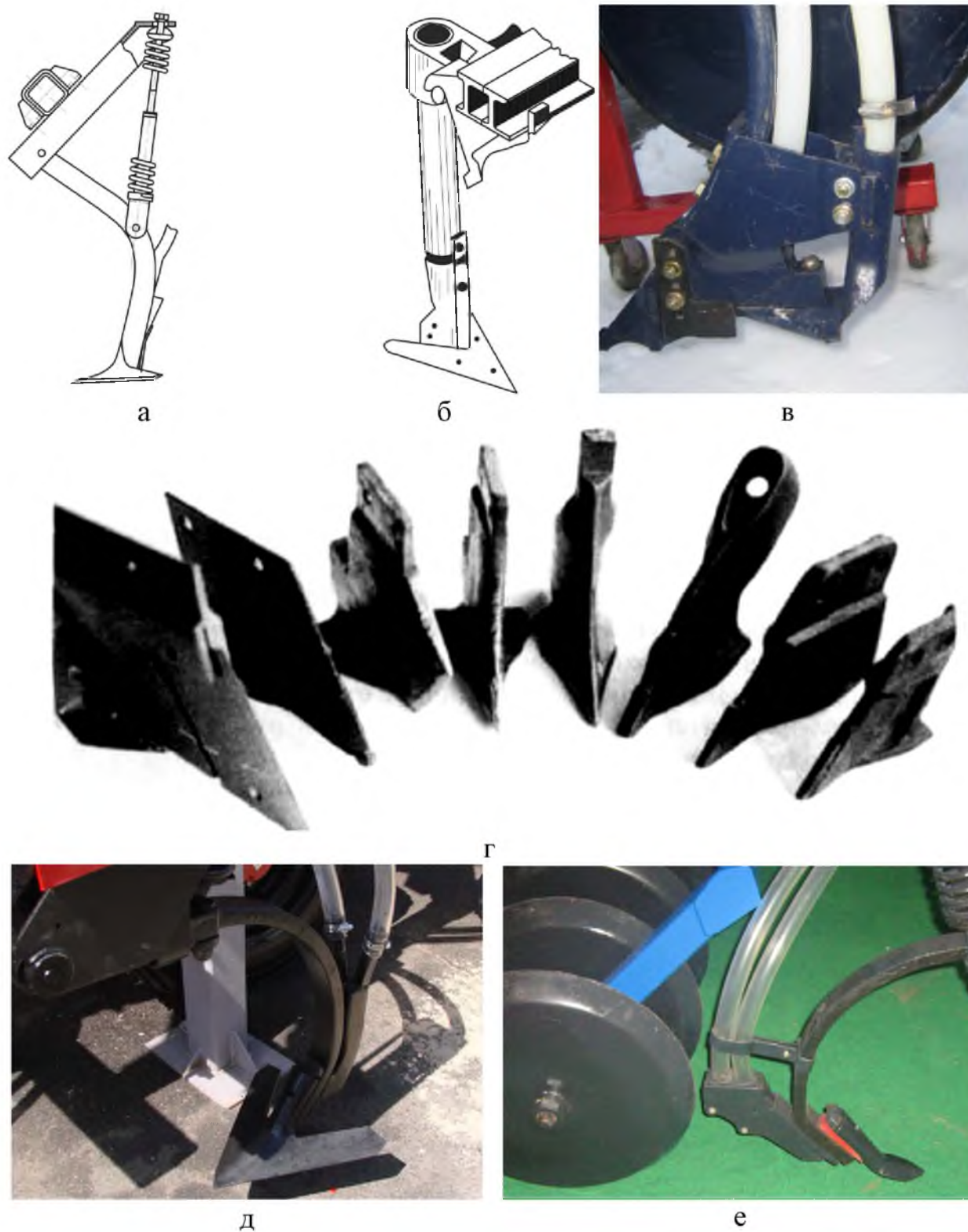
Рис 1.17 Сошники з гострим кутом входження:
