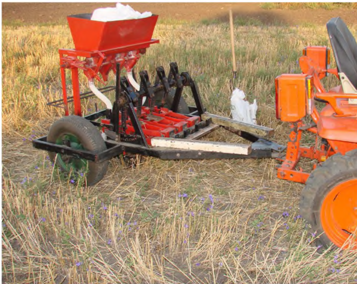
Рис. 3.13 Дослідний машинно-тракторний агрегат з мінісівалкою, укомплектованою сошниками для «прямої сівби КНТУ»
