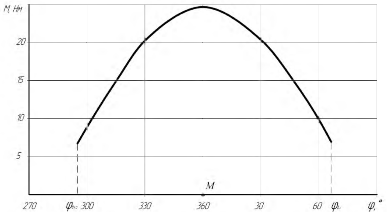
Рис. 2.7 Залежність зміни моменту опору при видаленні рослинних решток від кута повороту зубчастого диска-очисника (для одного зуба). ( R=125 мм, P_{\max}=50 Н)
