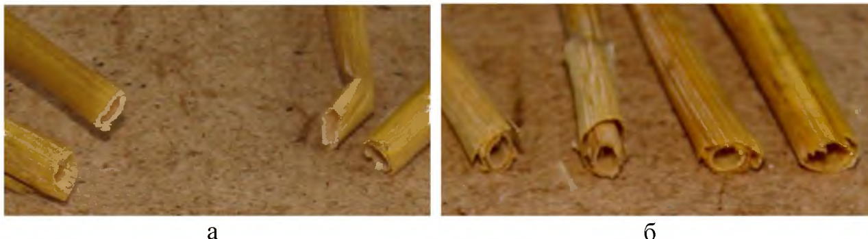
Рис. 4.13 Зрізи стебел пшениці, виконані при кутах різання:
