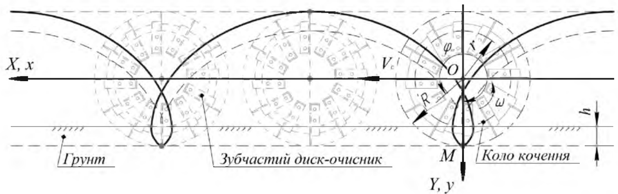
Рис. 2.3 Схема переміщення зубчастого диска-очисника сошника для прямої сівби
