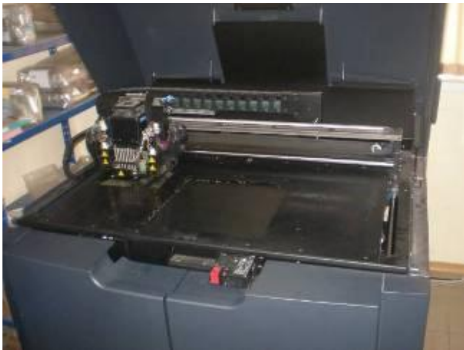
Рис. 2. Установка пошарового нарощування Objet EDEN 350V.
