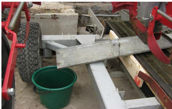
Рисунок 5 – Знімний лоток для скидання насіння за межі транспортерної стрічки на час стабілізації процесу імітації висіву
