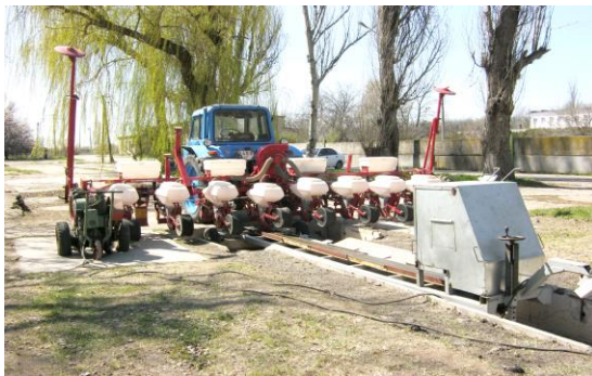
Рисунок 6 – Апробація роботи станда під час випробувань сівалки універсальної пневматичної точного висіву УПС-8
