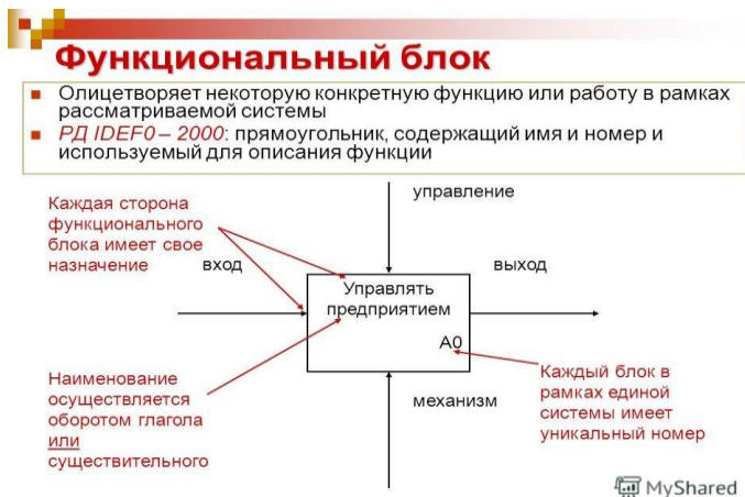
Рисунок 1 – Функціональний блок – основний елемент опису системи (процесу)
