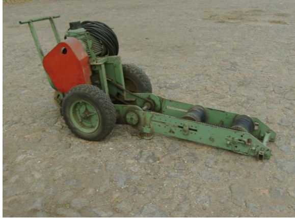
Рисунок 3 – Пересувна установка привода висівних апаратів випробуваної сівалки
