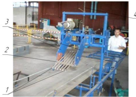
Рисунок 2 – Загальний вигляд стенда для імітаційного моделювання процесу взаємодії «робочий орган-ґрунт» з макетним зразком долотоподібного робочого органу: 1 – набір підкопувальних доліт; 2 – штаба; 3 – боковини; 4 – гвинт для регулювання глибини ходу робочого органу
