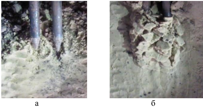
Рисунок 3 – Загальний вигляд викопувальних робочих органів круглої форми: а – закріплених на стенді в стані спокою; б – утворення тріщин під час роботи
