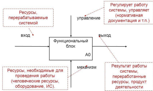
Рисунок 2 – Функції вхідних та вихідних стрілок (інтерфейсних дуг)
