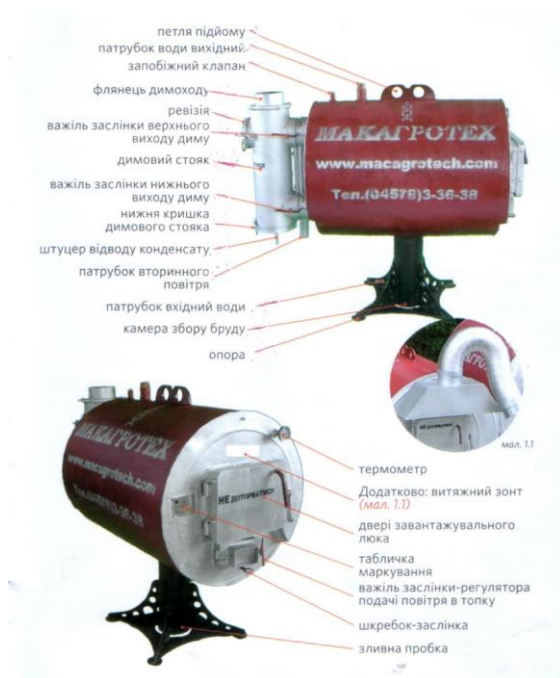
Рисунок 2 – Загальний вигляд теплогенератора ТГУ-800В
