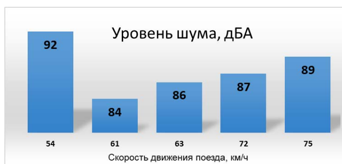
Рис. 2. Зависимость уровня шума от скорости грузовых поездов
