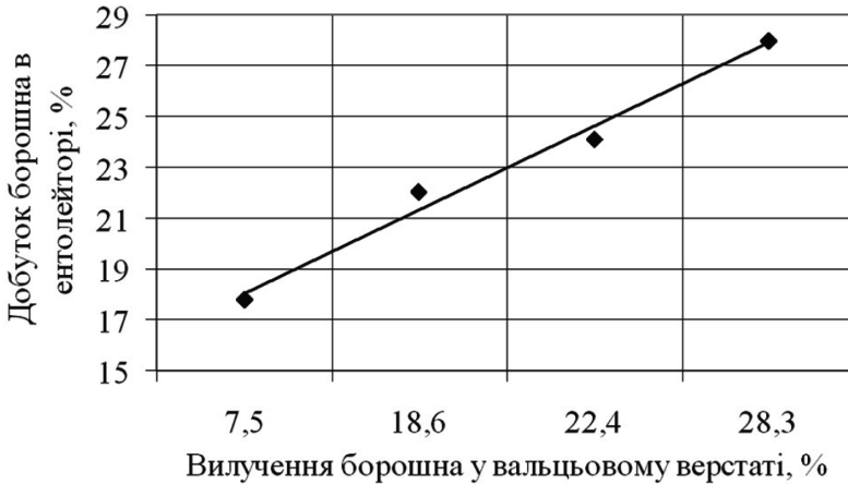
Рис. 3.10. Залежність виходу борошна вищого сорту в ентолейторі-дисмембраторі ЕСМ-1,5 від виходу борошна у вальцьовому верстаті на 1-й розмелювальній системі з врахуванням недосіву
