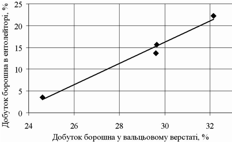
Рис. 3.16. Залежність виходу борошна вищого сорту отриманого у ентолейторі-дисембраторі ЕСМ-1,5 від виходу борошна вищого сорту отриманого у вальцьовому верстаті 3-ї розмелювальної системи з урахуванням недосіву
