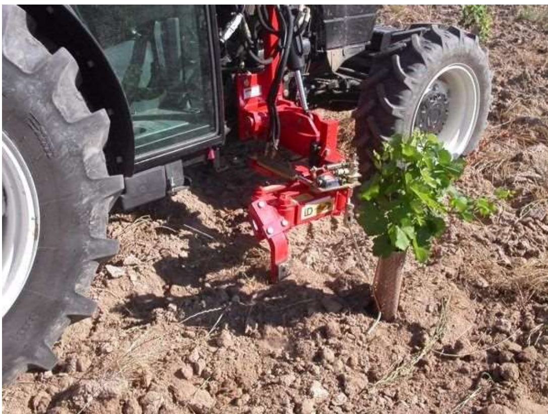
Рисунок 2 – Обладнання для обробітку міжстовбурної зони дерев у садах типу ID WEEDER
