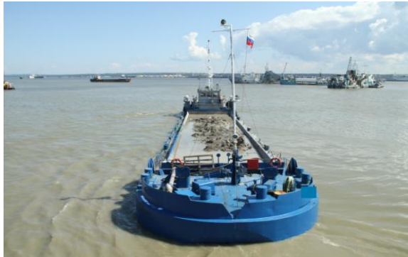
Рис. 1 – Транспортування пульпи баржою
