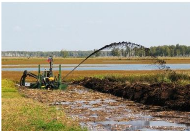
Рис.3 – Викид струменя пульпи безпосередньо від землесоса
