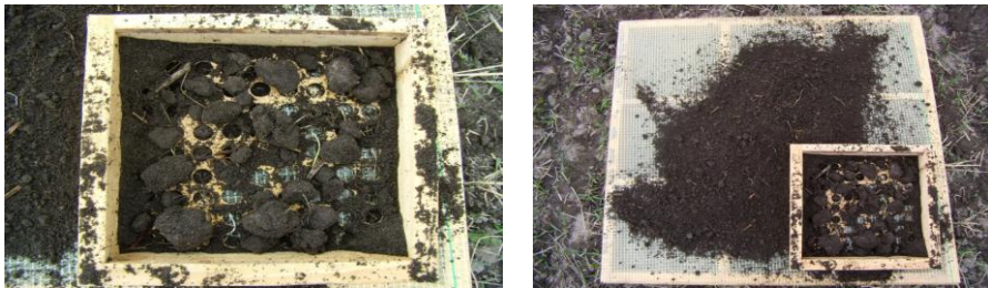
Рис.2 – Дослідження величини подрібнення озерного сапропелю при поверхневому їх внесенні вертикальними бітерами
