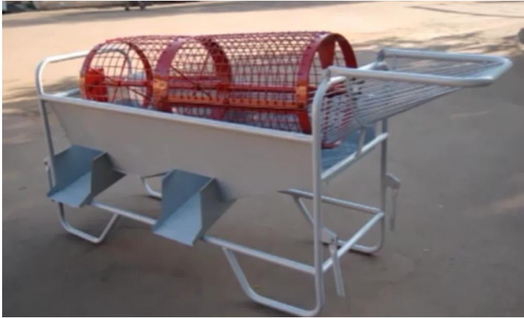
Рис. 1 – Загальний вигляд барабанної картопсортувалки МС-3
