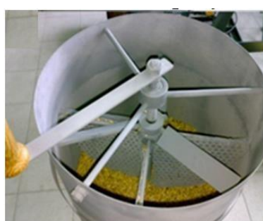
Рис.3 – Сушарка зернових із перфорованою спіралеподібною поверхнею у камері сушіння
