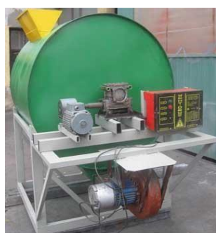
Рис.3 – Сушарка зернових із перфорованою спіралеподібною поверхнею у камері сушіння
