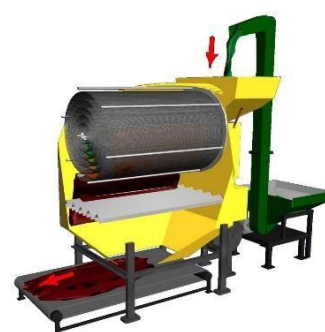
Рис.3 – Сушарка зернових із перфорованою спіралеподібною поверхнею у камері сушіння
