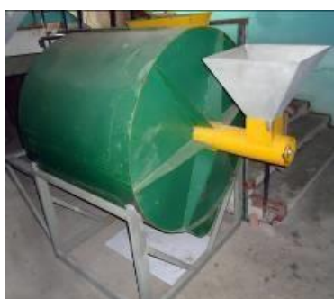
Рис.3 – Сушарка зернових із перфорованою спіралеподібною поверхнею у камері сушіння
