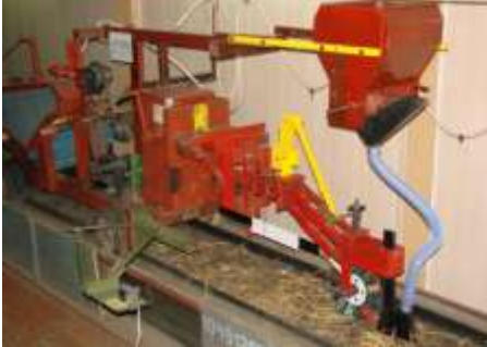
Рис. 8 Установка для дослідження якості виконання технологічного процесу прямої сівби експериментальним сошником
