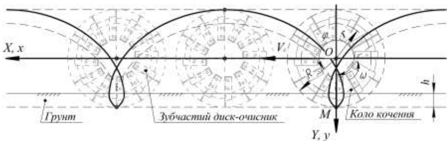
Рис. 1 Схема переміщення зубчастого диска-очисника сошника для прямої сівби
