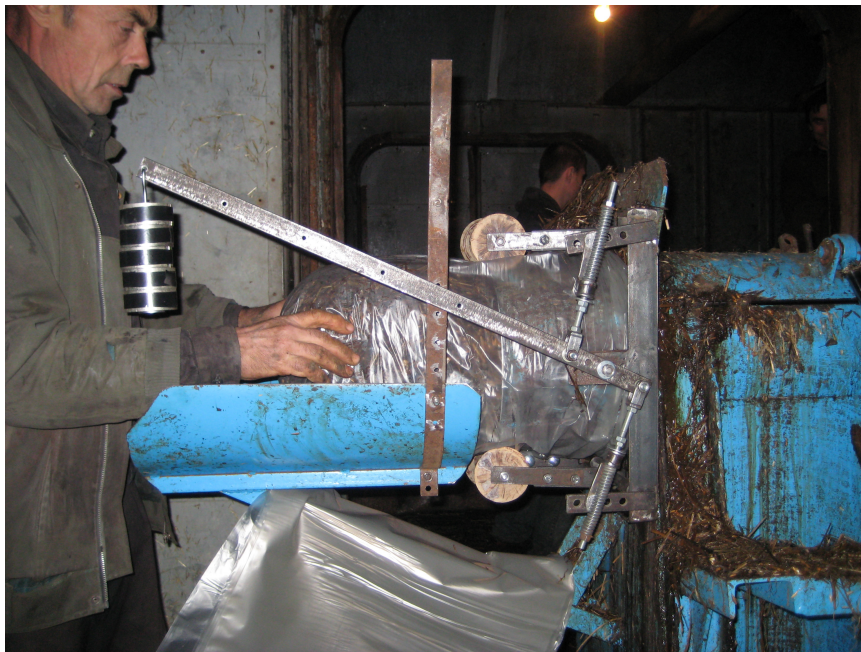
Рис. IV.2 – Виробничі випробування поршневого ущільнювача субстрату на базі ТОВ “Славута”
