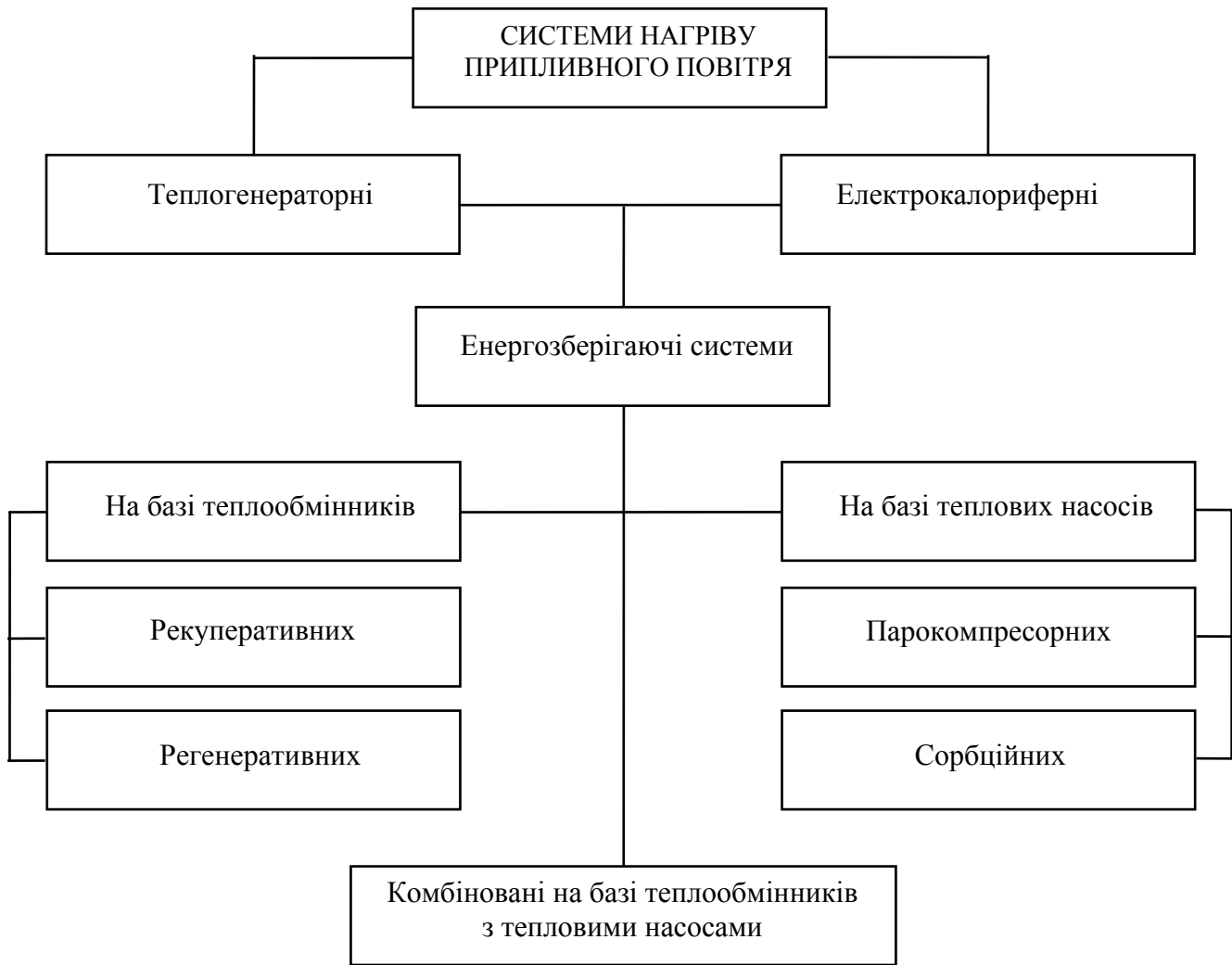
Рис. III.6 – Класифікація систем нагріву припливного повітря в спорудах закритого ґрунту
