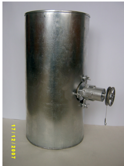
Рис. П.23 – Загальний вигляд приладу для визначення коефіцієнта бокового тиску субстрату
