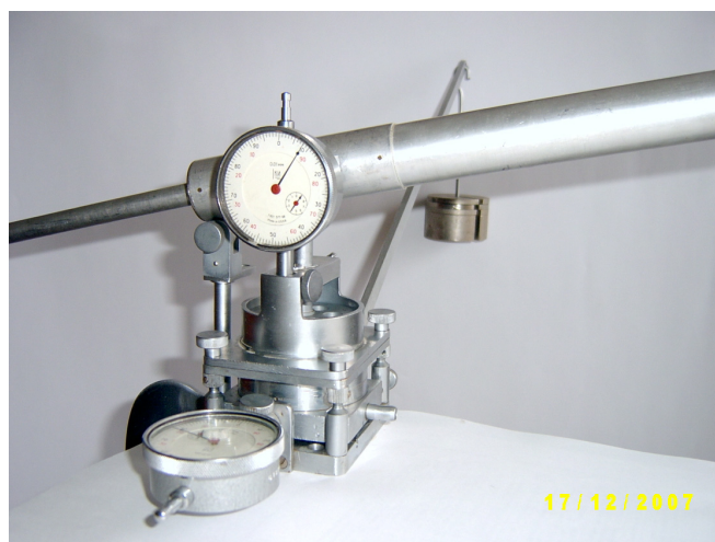
Рис. П.25 – Загальний вигляд приладу для визначення коефіцієнта тертя субстрату по сталі
