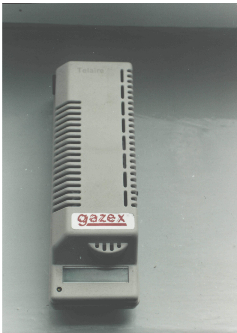
Рис. III.30 – Прилад для вимірювання концентрації CO 2 “gazex Q01”
