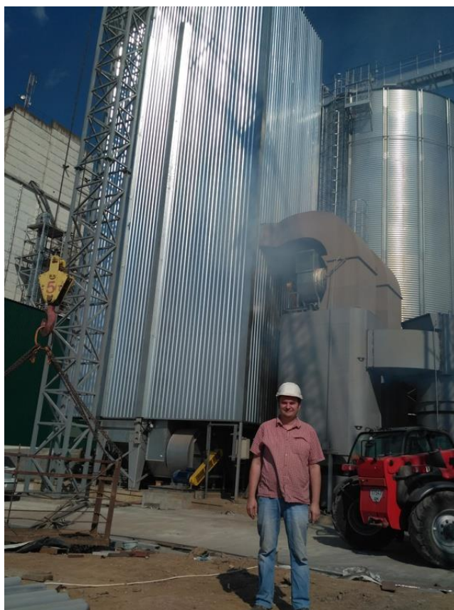
Рис.1. Зерносушарка BRICE-BAKER SCN-18/48 з рекуперацією, на альтернативних видах палива.
