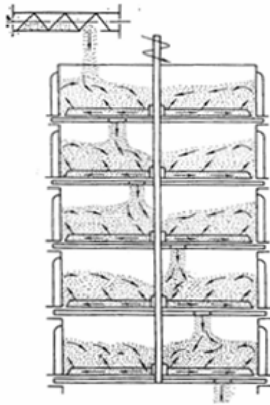
Рис. 3.5. Схема руху частинок м'ятки в жаровні при потоковому, безперервному жарінні
