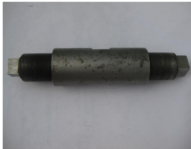
Рис. 4.1. Контейнер для визначення потенціалу масопереносу.
