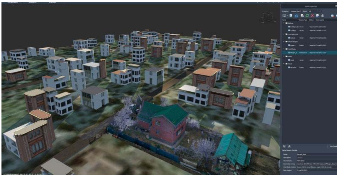
Рис. 6. Візуалізація тривимірної моделі урбанізованої території як елементу цифрового кадастру в межах геодезичного забезпечення землеустрою [16]
