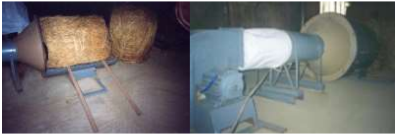
Рис.5 – Сушіння рулонів із диференційованим підводом сушильного агента
