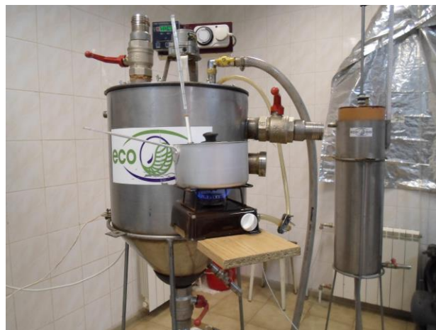
Рис. 5. Экспериментальная биогазовая установка
