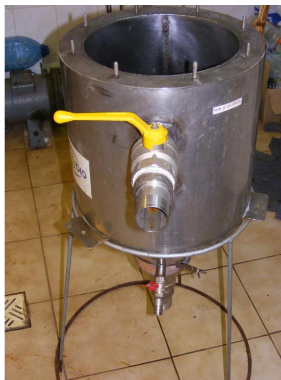
Рис. 6. Конструкция метантенка экспериментальной биогазовой установки
