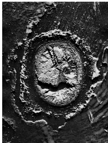
Рис. 3. Характер разрушения сварочной точки
