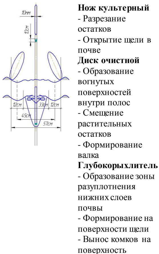
Рис. 2. Функциональные особенности рабочих органов секции для формирования полос под кукурузу (а) и сою (б)
