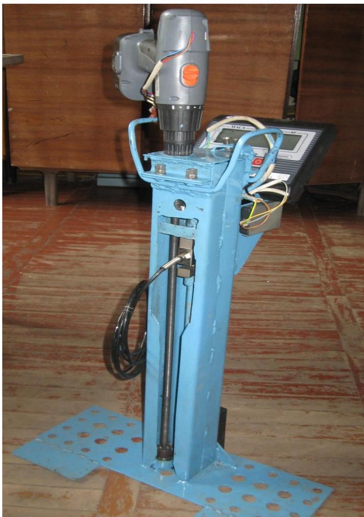
Рисунок 3.1– Внешний вид твердомера
