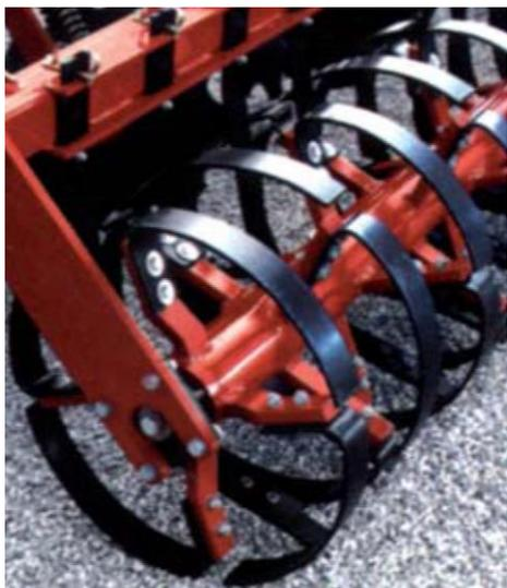
Рисунок 1.5 – Пружинный каток
