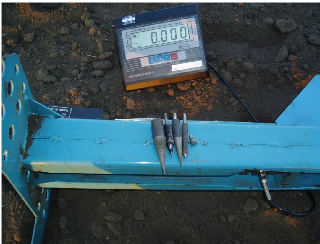
Рисунок 3.4 – Плунжеры для определения твердости почвы цилиндрической и конической форм с двойным углом при вершине  $10^\circ$ ,  $14^\circ$  и  $18^\circ$
