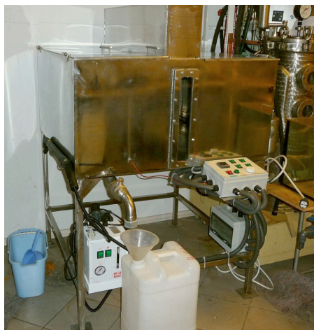
Fot. 1. Bioreaktor do produkcji biopreparatów w skali semitechnicznej (poj. 0,5 \text{ m}^3 ) w laboratorium biotechnologii środowiska WO UR w Krakowie [P. Kaszycki]
